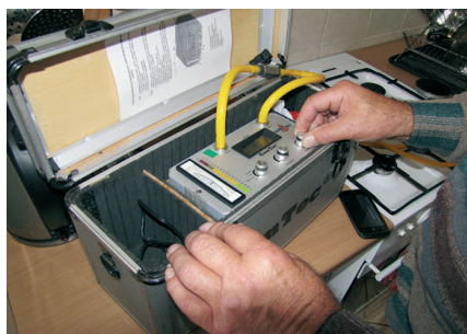
13. Urządzenie ComTec (metoda objętościowa) do sprawdzania nieszczelności oraz klasyfikacji sprawności instalacji gazowych
